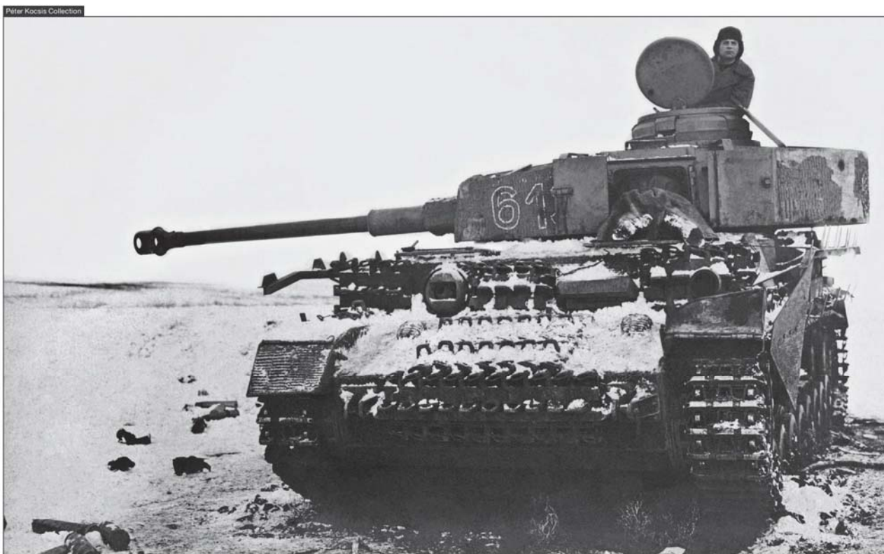
A jobb oldali sárvédőn látható egyetlen tartalék lánctag alapján ez egy Krupp gyártású jármű. Akárcsak a gyár legtöbb korai gyártású páncélosán, a Zimmeritítés itt is viszonylag mély rovátkolású. A toronykötényezésen a Nibelungen Werke megoldásához hasonló a Zimmeritítés, de itt hat keskenyebb sorban láthatóak a függőleges minták. A jobb oldalon a II. sorozatú köténytartó sínen a két első háromszög már csonkított, míg a bal oldalon még az eredetiek láthatóak. Jól megfigyelhető a toronykötény hátsó ajtószárnyának átfedéses kialakítása.
